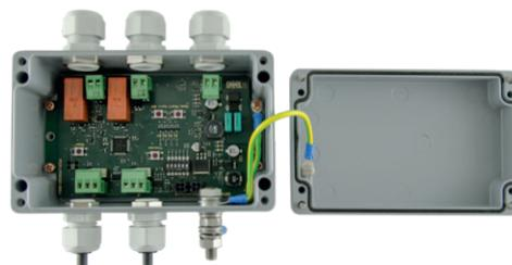
Le contrôle par différentiel thermique sert à l'identification des défauts de l'installation, plus particulièrement des lampes qui ne seraient pas raccordées. Le contrôle est automatiquement activé dès que les lampes sont éteintes.
