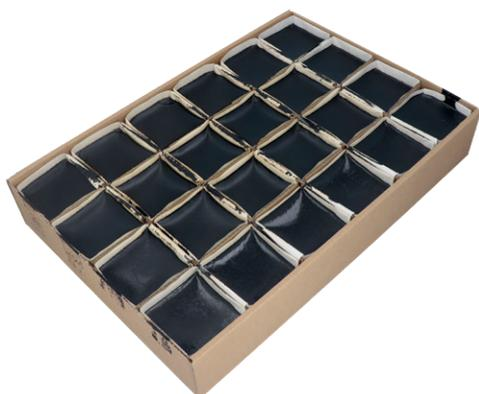
Pour être utilisé, la masse d'étanchéité bitume recommandée doit être chauffée de 160° à 180° C en remuant constamment. Le remplissage se fait à l'aide d'un récipient à bec ou d'un bec de coulée. Le scellement en excès doit être enlevé mécaniquement après refroidissement complet.
